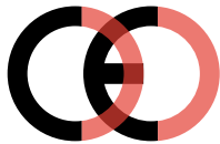
Falsche CE-Kennzeichnung (zu dicht)
